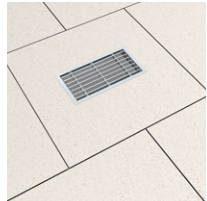
Ventilationsgaller infällt i golvplatta 100 x 300 mm. Fri area: 216 cm 2 150 x 400 mm. Fri area: 420 cm 2
